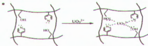
รูปที่ 37 (a) Magnetic P(4-VP-co-HEMA) hydrogel ในสารละลายโลหะ UO_2^{2+} และ magnetic hydrogel (b) ก่อน และ (c) หลังการดูดซับโลหะ UO_2^{2+} (d) สารละลายหลังจากการกำจัดโลหะ UO_2^{2+} โดย magnetic hydrogel และ (e) กลไกของ magnetic p(4-VP-c-HEMA) hydrogel ในการดูดซับโลหะ UO_2^{2+} [46]
