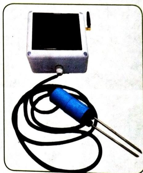
△ ภาพที่ 3 ชุดอุปกรณ์ตรวจวัดปริมาณความชื้นในดินด้วยวิธี Resistive Wireless Sensor
