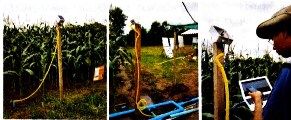
△ ภาพที่ 2 การติดตั้งใช้งานอุปกรณ์ตรวจวัดค่าความชื้นในดินและควบคุมปริมาณความชื้นในดินแบบแม่นยำอัตโนมัติจริงในแปลงข้าวโพดหวาน
