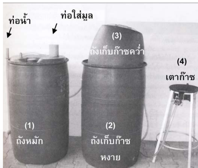
ภาพที่ 53 ถังพลาสติกหมักก๊าซชีวภาพขนาด 200 ลิตร
