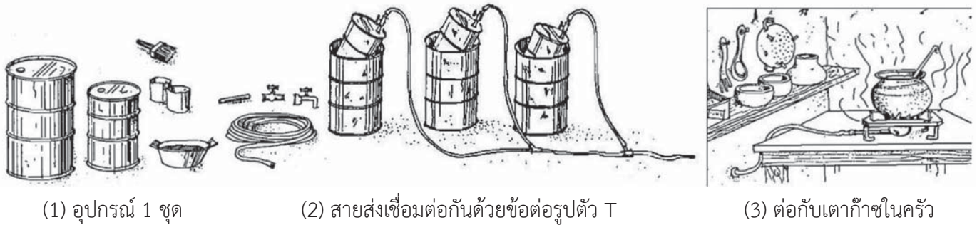
ภาพที่ 52 การผลิตก๊าซชีวภาพจากมูลสัตว์แบบขององค์การเอฟเอโอ (FAO)
