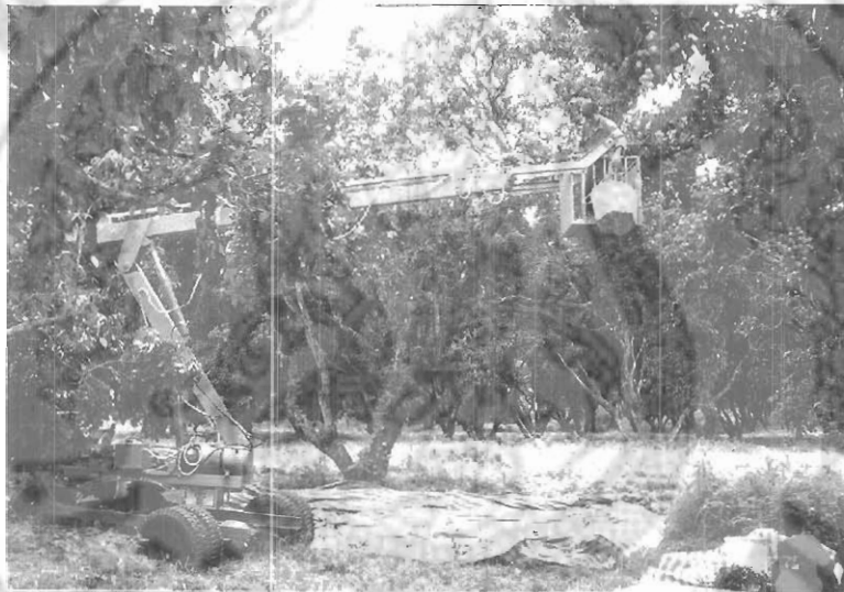
รูปที่ 3.6 รถกระเช้าเก็บเกี่ยวลำไยต้นแบบ ที่มา : เสมอขวัญ. 2546.
