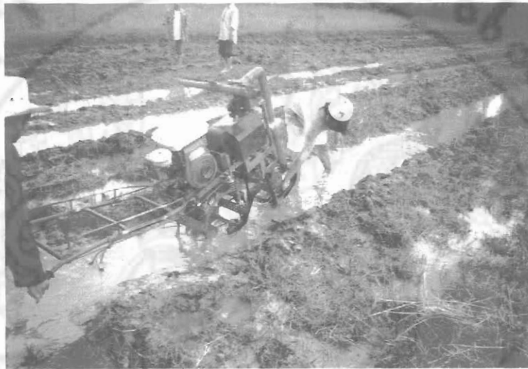
รูปที่ 4.15 ปัญหาการอุดตันของเศษหญ้าและโคลนที่ตะแกรงกรองทางเข้า
