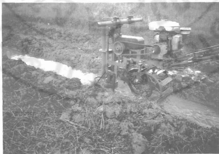
รูปที่ 4.16 ปัญหาการเสียหายของโซ่เนื่องจากโซ่ต้องสัมผัสน้ำและความชื้น
