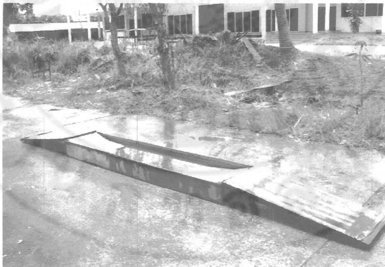
รูปที่ 6.2 กระบะเหล็ก สำหรับจำลองร่องน้ำ
