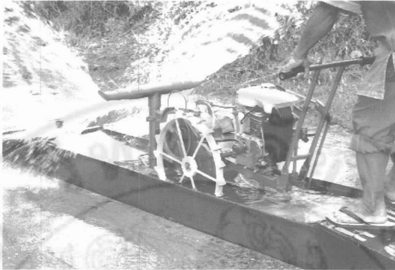
รูปที่ 6.3 การควบคุมเครื่องให้น้ำเคลื่อนที่ผ่านกระบะเหล็ก ซึ่งใส่น้ำไว้เกือบเต็ม
