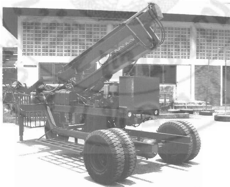
ภาพที่ 4.11 แสดงภาพถ่ายเครื่องเก็บเกี่ยวลำไยต้นแบบ
