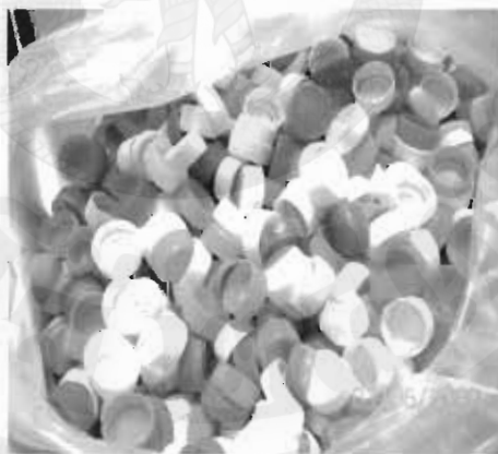
ภาพที่ 7 ขวดพลาสติกชนิดต่างๆ ที่ดัดแปลงมาใช้เป็นวัสดุกรองหาง่ายและราคาประหยัด
