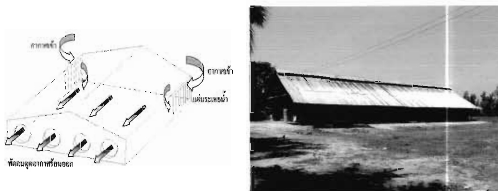
ภาพที่ 4.1 แสดงลักษณะการไหลของอากาศภายในโรงเรียนมหาวิทยาลัยแม่โจ้
