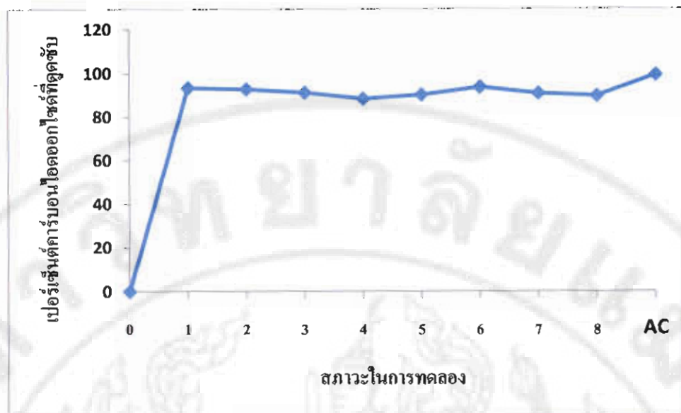
ภาพที่ 24 ความสามารถในการดูดซับคาร์บอนไดออกไซด์ที่ละลายในน้ำของถ่านกัมมันต์ที่ผลิตได้และถ่านกัมมันต์จากกะลามะพร้าว ณ สถานะการทดลองดังตารางที่ 3.2 (โดย AC คือ Activated Carbon from Bituminous Coal)
