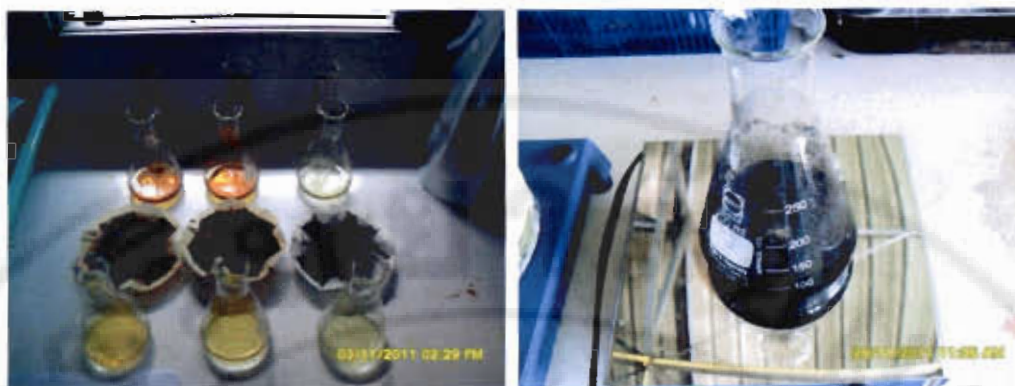
ภาพที่ 10 การเตรียมสารเคมีในกระบวนการหาค่า Iodine number
