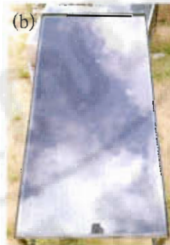
รูปที่ 14 (a) ลักษณะการติดตั้งแผงโซลาร์เซลล์แบบพับงอได้ โดยมีการติดตั้งเป็นลักษณะทรงจั่ว ทรงโค้ง และทรงลาดเฉียงตรง และ (b) โซลาร์เซลล์แบบเดิมติดตั้งแบบเฉียงตรง
