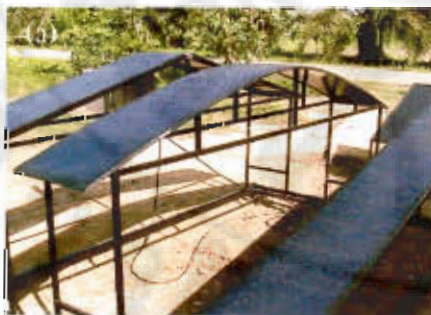
รูปที่ 14 (a) ลักษณะการติดตั้งแผงโซลาร์เซลล์แบบพับงอได้ โดยมีการติดตั้งเป็นลักษณะทรงจั่ว ทรงโค้ง และทรงลาดเฉียงตรง และ (b) โซลาร์เซลล์แบบเดิมติดตั้งแบบเฉียงตรง
