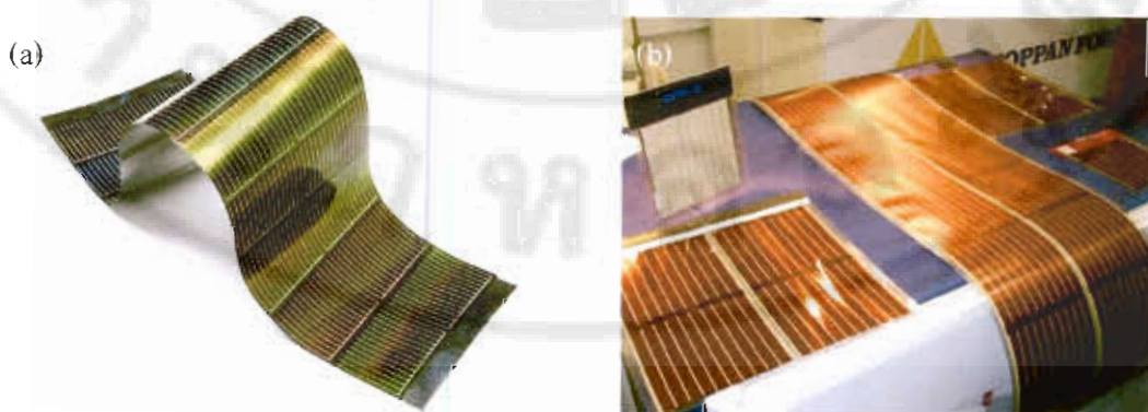
รูปที่ 7 (a) โพลีซิลิโคนแบบฟิล์มบาง CIGS (Nanosolar) และ (b) โพลีซิลิโคนแบบพอลิเมอร์ (Konarka)
