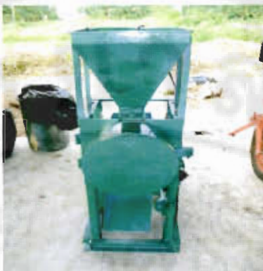
ภาพที่ 6 ต้นแบบเครื่องอัดเม็ดปุ๋ยอินทรีย์จากลำไยตกเกรด
