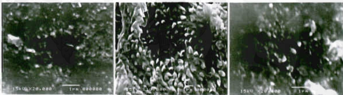
ภาพที่ 15 SEM micrographs ของอนุภาคนาโนไคโตซานโดยได้จากการเตรียมด้วยวิธีไอออนิกเจลชัน ใช้ไคโตซาน 85 %DD ขนาดโมเลกุล 80 kDa ที่ความเข้มข้น 0.5 % (w/v) และเติม trehalose 1%
