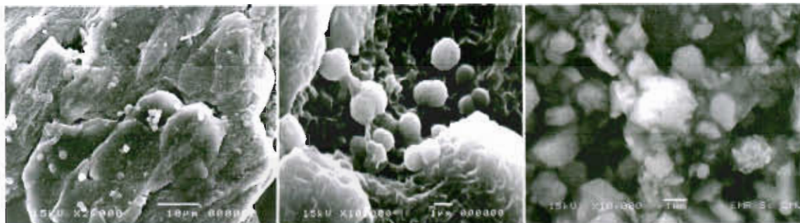
ภาพที่ 11 SEM micrographs ของอนุภาคนาโนไคโตซานที่กำลังขยายต่างๆ โดยได้จากการเตรียมด้วยวิธีไอออนิกเจลชัน ใช้ไคโตซาน 95 %DD ขนาดโมเลกุล 200 kDa ที่ความเข้มข้น 0.5 % (w/v) และเติม trehalose 1%
