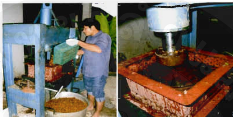
ภาพที่ 11 การบีบอัดเอาน้ำลำไยด้วยเครื่องอัดไฮโดลิก
