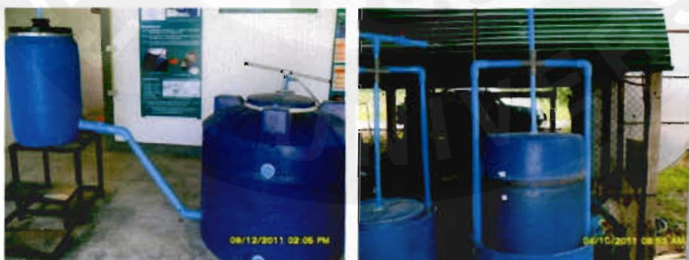
ภาพที่ 27 ลักษณะถังหมักไบโอแก๊สที่ใช้ในการทดลอง
