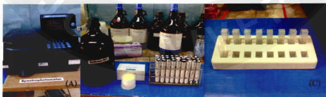
ภาคผนวกที่ 13 (A-C) เครื่อง Spectrophotometer สารเคมี และหลอด Quartz Cuvette วิเคราะห์คลอโรฟิลล์-เอ (Chlorophyll -a)
