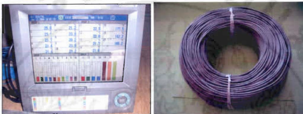
รูปที่ 3.3 เครื่องบันทึกอุณหภูมิ Memmert รุ่น DO 6057 และเทอร์โมคัปเปิล ชนิด K
