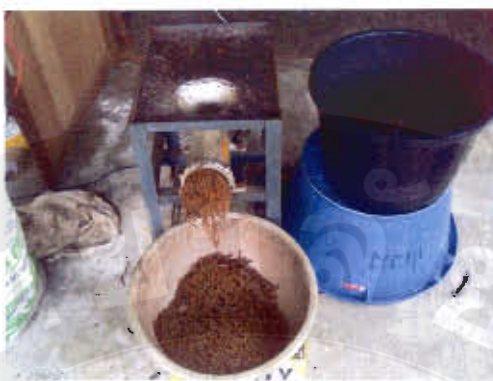
ภาพผนวกที่4 การอัดเม็ดอาหารทดลองด้วยเครื่อง mincer
