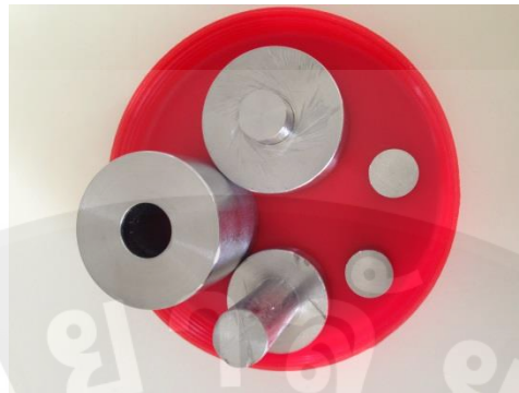
รูปที่ 3.3 แม่พิมพ์โลหะซึ่งมีขนาดเส้นผ่าศูนย์กลาง 15 มิลลิเมตร
