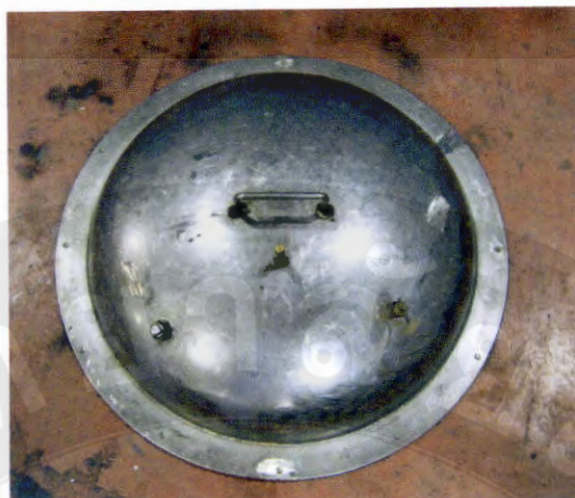
ภาพ 18 ฝาถังหมักสุญญากาศแดนเลส
