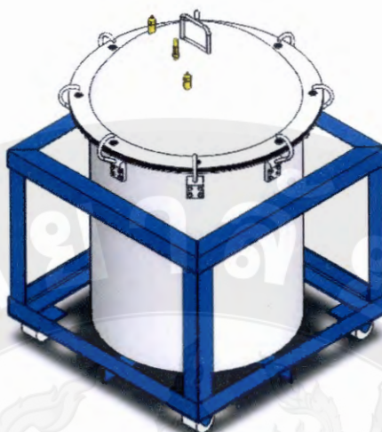
ภาพ 12 แบบถังหมักสแตนเลสสุญญากาศ
