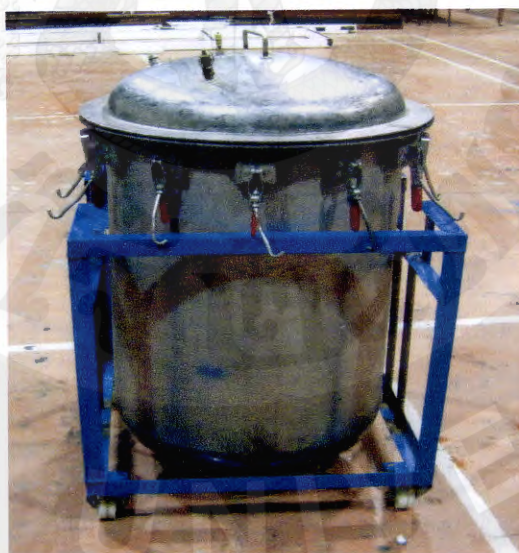
ภาพ 17 ถังสุญญากาศสแตนเลสต้นแบบเมื่อสร้างเสร็จ
