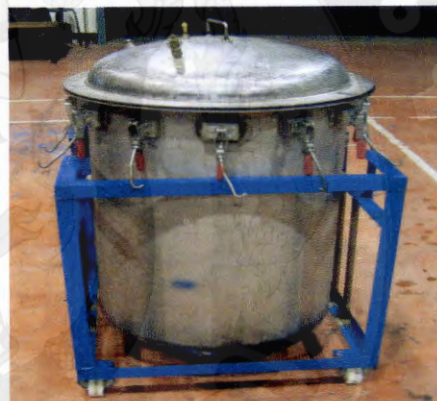
ภาพ 11 เครื่อง ทำเป็นสุญญากาศ และตั้งสแตนด์แบบหลังจากการดูดอากาศออก
