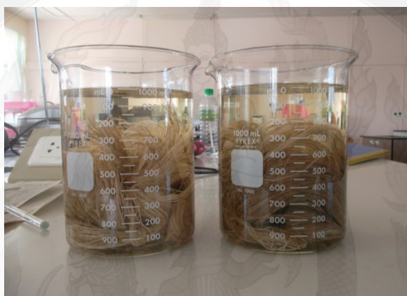
รูปที่ 20 การปรับปรุงพื้นผิวเส้นใยด้วยสารคู่ควบ
