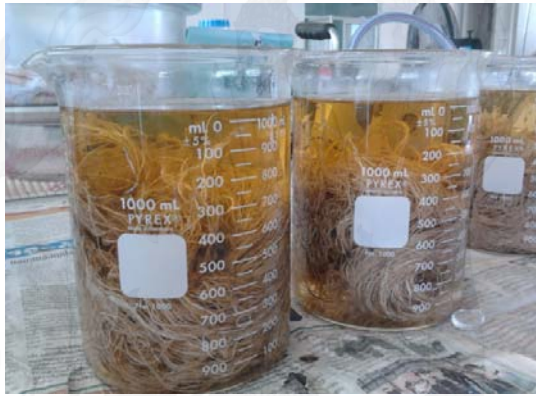
รูปที่ 18 การปรับปรุงพื้นผิวเส้นใยกัญชงด้วยโซเดียมไฮดรอกไซด์
