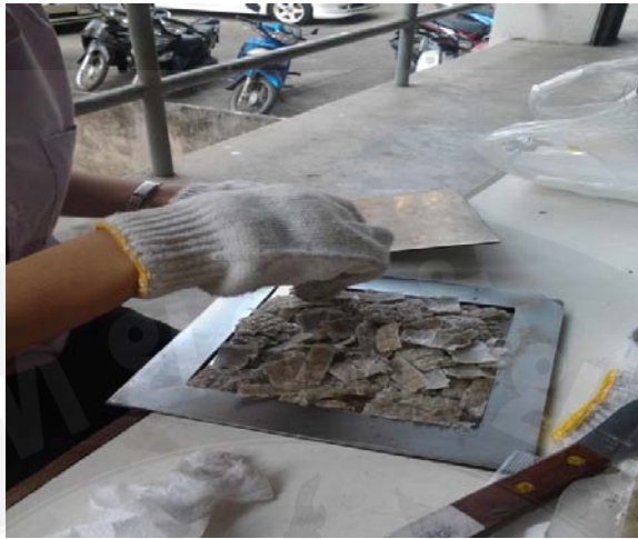
รูปที่ 22 เทวัสดุผสมลงในแม่แบบเพื่อเตรียมชิ้นงาน โดยวิธีการกดอัดขึ้นรูป
