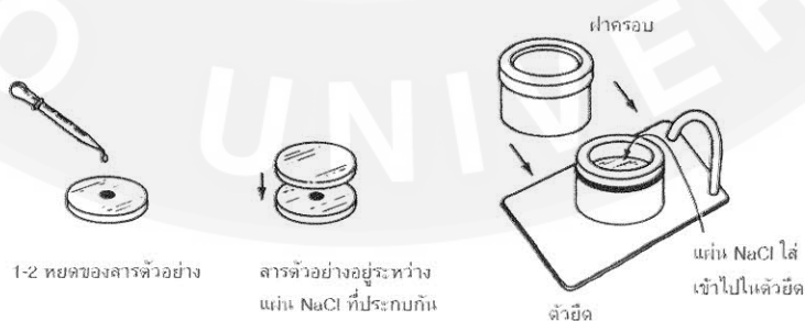
ภาพที่ 6 การเตรียมสารตัวอย่างของเหลวโดยเตรียมเป็น Thin-film [18]
