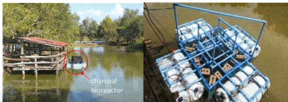
ภาพที่ 5 การติดตั้ง Bioreactor ที่ใช้ถ่านไม้ในบ่อปลา
