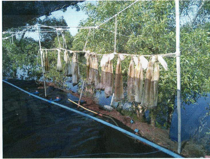
ภาพผนวกที่ 7 ลักษณะทั่วไปของถุงกรองหลังจากถูกใช้งานในการทดลอง
