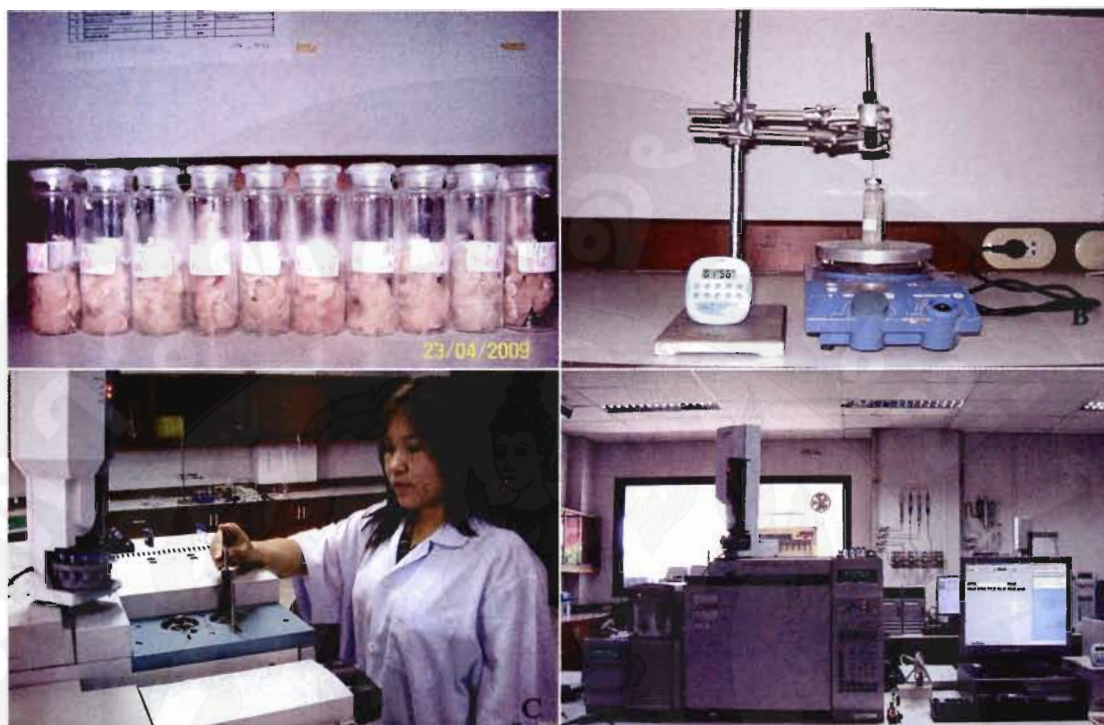
ภาพ 7 (A) ตัวอย่างเนื้อปลานิล (B) สกัดที่อุณหภูมิ 65 องศาเซลเซียส และฉีดไฟเบอร์นาน 12 นาที (C) นำ SPME เสียบที่เครื่อง GC/MS (D) เครื่อง GC/MS ทำการประมวลผล
