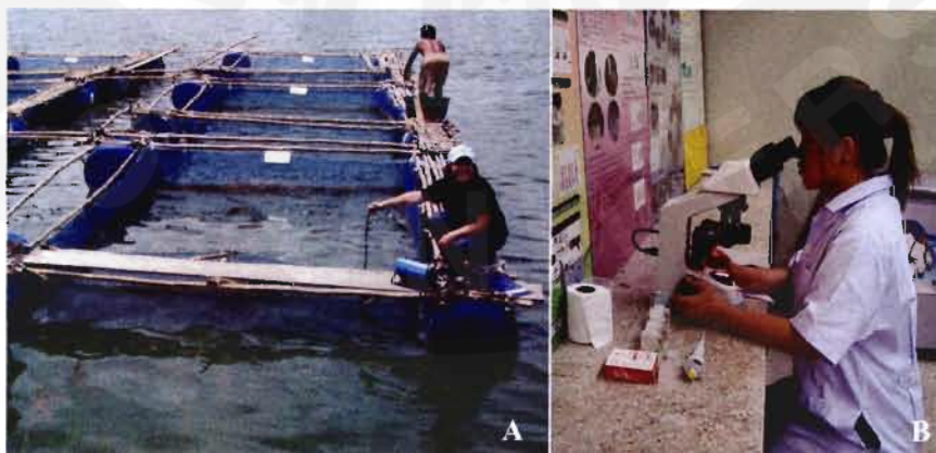
ภาพ 11 (A) การตรวจสอบคุณภาพน้ำในภาคสนาม โดยใช้ TOA multimeter รุ่น WQC-22A (B) การนับปริมาณชนิดแพลงก์ตอนพืชภายใต้กล้องจุลทรรศน์ภายในห้องปฏิบัติการ
