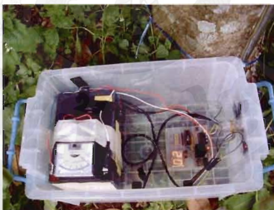
ภาพ 18 การประกอบอุปกรณ์และวงจรในการเก็บข้อมูลจากเซนเซอร์คลื่นไมโครเวฟ
