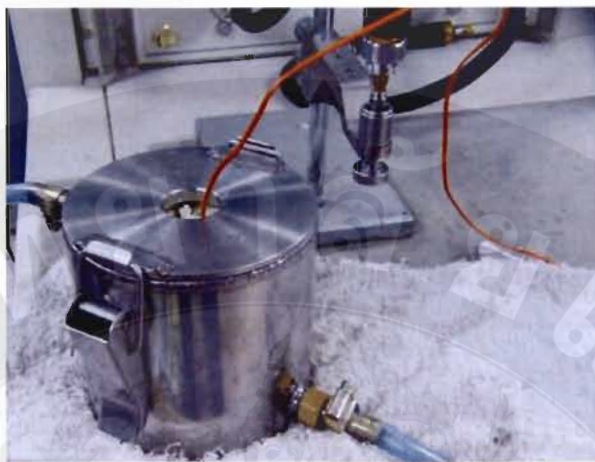
ภาพ 38 การตรวจสอบอุณหภูมิของตัวอย่างเนื้อทุเรียนก่อนการวัดค่าไดอิเล็กตริก
