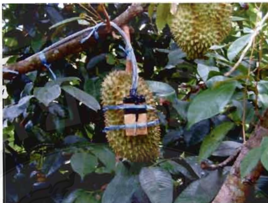
ภาพ 19 ลักษณะการติดตั้งเซนเซอร์คลื่นไมโครเวฟบนผลทุเรียนบนต้นไม้
