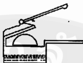
ภาพ 3 หลักการทำงานของเครื่องคั้นแบบคันโยก
