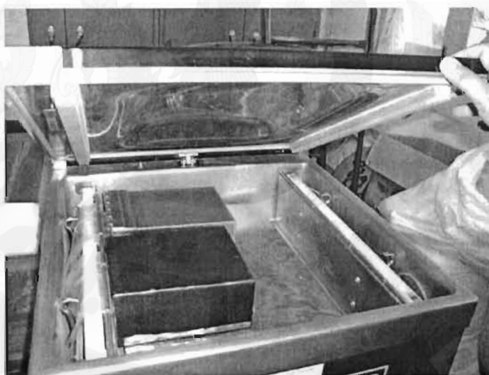
ภาพ 10 การนำบล็อคที่ใส่ถุงที่บรรจุข้าวกล้อง เข้าเครื่องแพ็คแบบสูญญากาศ
