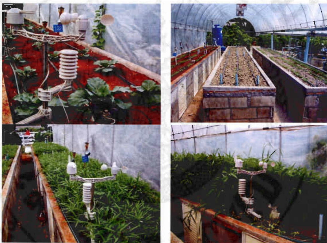
ภาพ 7 การปลูกผักบุ้งจีนเป็นพืชทดลองของการทดลองที่ 1 และ 3 (พร้อมด้วยชุดเครื่องมือตรวจอากาศ weather station)
