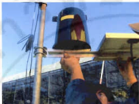
ภาพผนวก 9 การประกอบแผง solar cell ใต้ถังรับปริมาณน้ำฝนกับเสา
