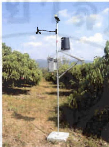
ภาพผนวก 13 สถานีวัดอากาศที่ติดตั้งเสร็จสมบูรณ์
