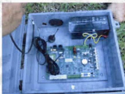
ภาพผนวก 5 การประกอบอุปกรณ์วัดอุณหภูมิเข้ากับกล่องควบคุม
