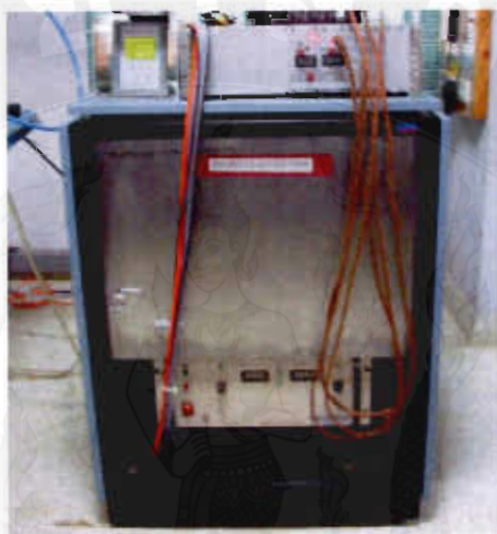
ภาพ 3 ระบบสร้างความต่างศักย์แรงดันสูงแบบห้วง
