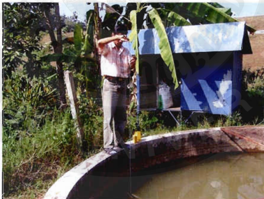
ภาพผนวก 12 ตรวจสอบวัดความโปร่งแสงของน้ำในบ่อเลี้ยงปลา
