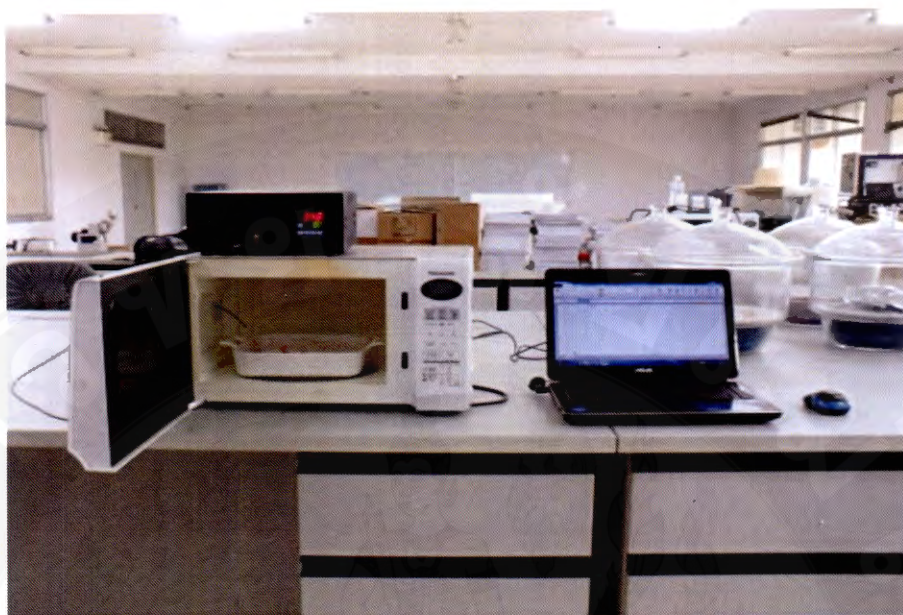
ภาพผนวก 3 เครื่องอบแห้งด้วยคลื่นไมโครเวฟที่ใช้ในการทดลอง
