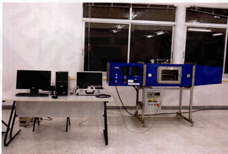
ภาพผนวก 2 เครื่องอบแห้งด้วยลมร้อนแบบถาดที่ใช้ในการทดลอง
